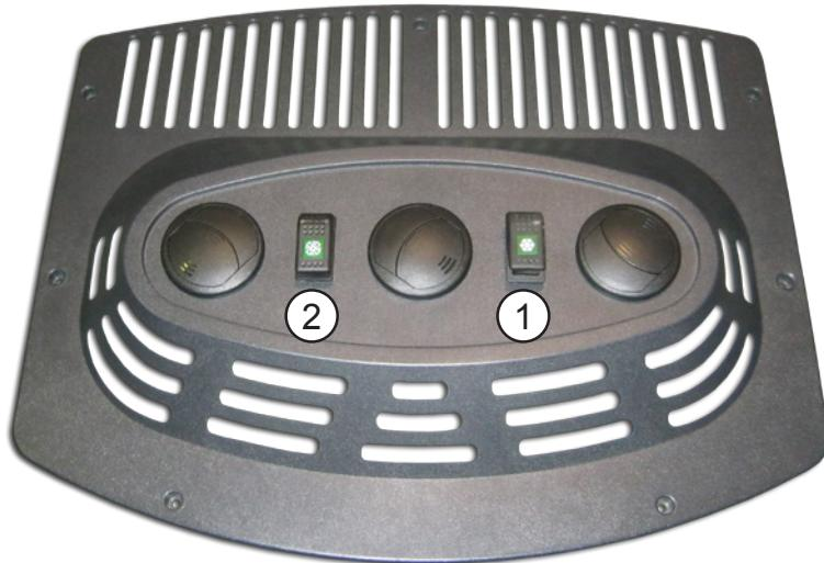
1. Interruptor On/off. 1<sup>a</sup> velocidad del soplador.
