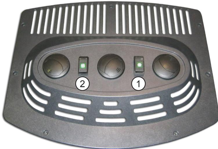
1. Interruttore On/Off. 1<sup>a</sup> velocità del ventilatore.
