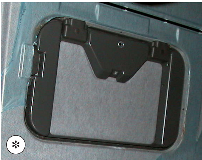
Standard-Fahrerhaus und Iveco Stralis seit 2008: EPDM-Dichtung 30 x 25
