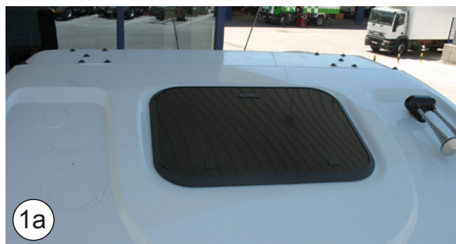
Kabina Stralis sprzed roku 2008: Uszczelka EPDM 40 x 40
