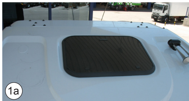
Cabina Stralis anterior a 2008: Junta EPDM 40 x 40
