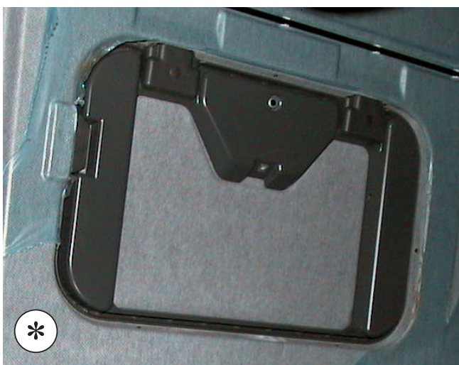
Cabina Standar y Cabina Stralis desde 2008: Junta EPDM 30 x 25
