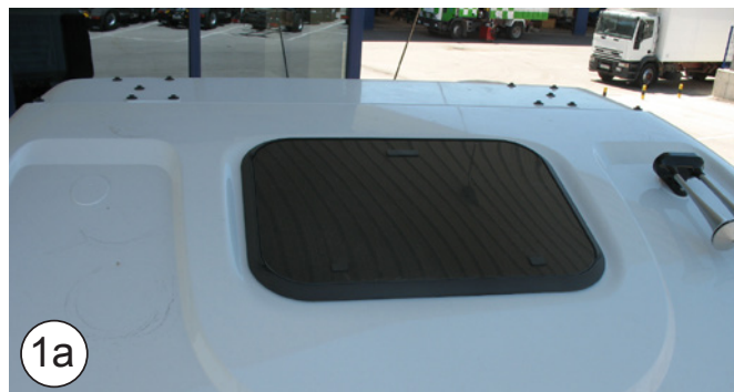
Iveco Stralis cabine avant 2008: Joint EPDM 40 x 40
