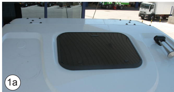
Iveco Stralis Fahrerhaus vor 2008: EPDM-Dichtung 40 x 40
