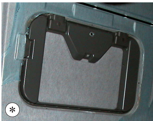
Kabina Standar i Kabina Stralis od roku 2008: Uszczelka EPDM 30 x 25
